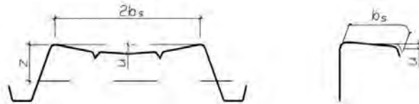
Figura C4.2.25 -Incurvamento delle piattabande
